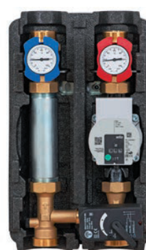
tubra®-PGM groupe de pompes vanne mélangeuse avec vanne mélangeuse 3 voies, régulation à température constante et support mural, k_{VS} 8: 35 kW ( \Delta T 10 K), 70 kW ( \Delta T 20 K)
