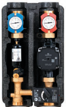
tubra®-PGR Groupe de pompes avec vanne mélangeuse et séparateur de magnétite avec support mural, 35 kW ( \Delta T 10 K), 70 kW ( \Delta T 20 K)
