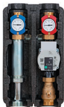
tubra®-PGR groupe de pompes sans vanne mélangeuse avec support mural, 35 kW ( \Delta T 10 K), 70 kW ( \Delta T 20 K)
