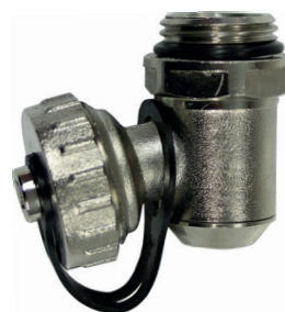
Vanne de service (Collecteur en acier inox. 1") 040711 Vanne de service pour rincer, remplir et vider le collecteur
